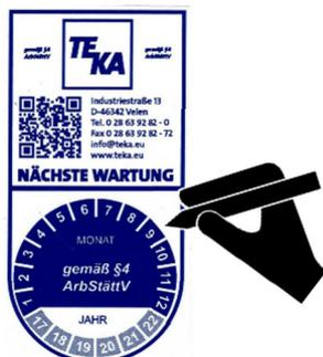
En el aparato está colocado un adhesivo de mantenimiento. En el momento de la puesta de marcha, es preciso indicar en el adhesivo la fecha para el siguiente mantenimiento. El mantenimiento se tiene que efectuar a más tardar 12 meses después de la primera puesta en marcha.
